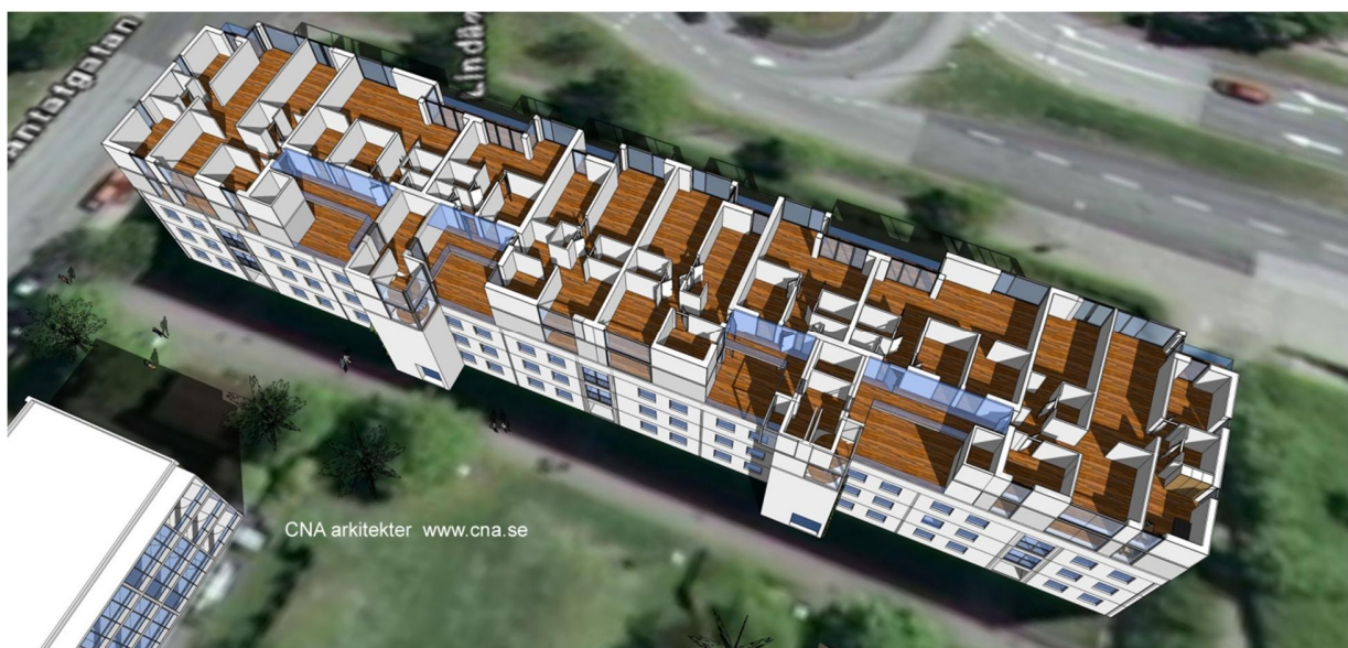
Figur 7.13 Påbyggnad med nya lägenheter, ny klimatskärm och två nya trapphus med hiss på utsidan av den befintliga byggnaden (bild Christer Nordström).
